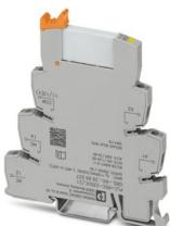
Interface PLC, compuesta por borne de base PLC-BSC.../21 con conexión por tornillo y relé miniatura enchufable con contacto de potencia, para el montaje sobre carril NS 35/7,5, 1 contacto comutado, tensión de entrada 230 V AC/220 V DC
